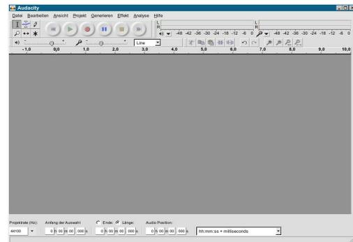
Das gegebenenfalls auf mehreren Spuren liegende Audiomaterial kann nun mit den PC-gängigen Befehlen **Strg + c / v / x** oder über den Menüpunkt **Bearbeiten** (gegebenenfalls von einer Spur in die andere) kopiert oder eingekürzt werden, Bearbeitungsschritte lassen sich wie üblich rückgängig machen mit **Strg + z** bzw. **Bearbeiten > Rückgängig**.
